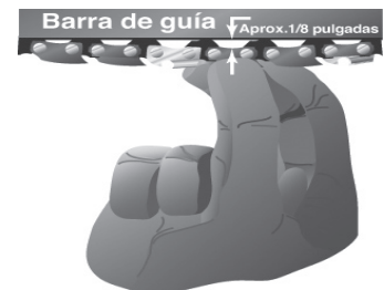
Figura 8 - Compruebe la tensión de la cadena
